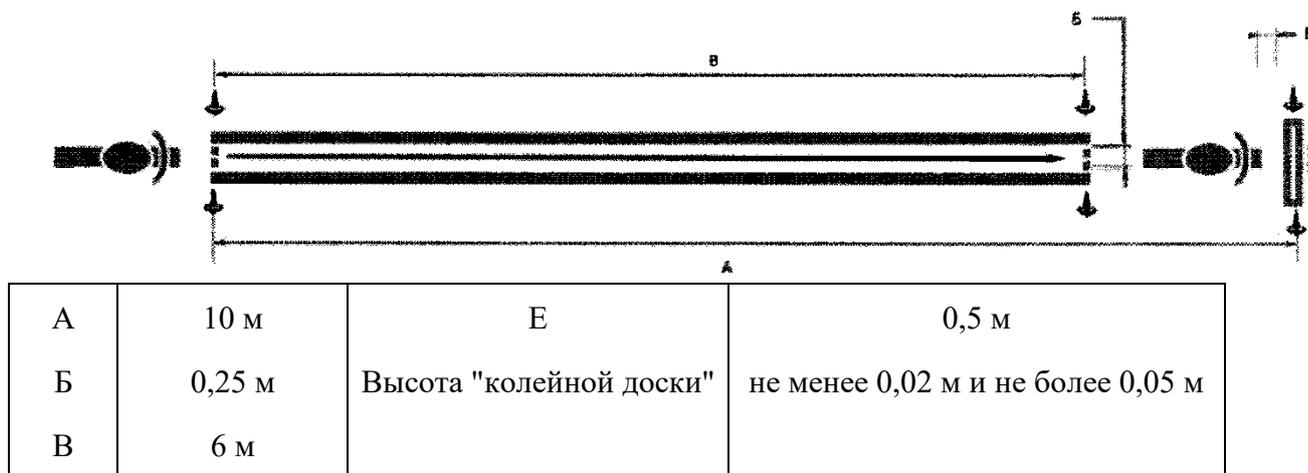
Рисунок 1. Схема и размеры упражнения N 1
